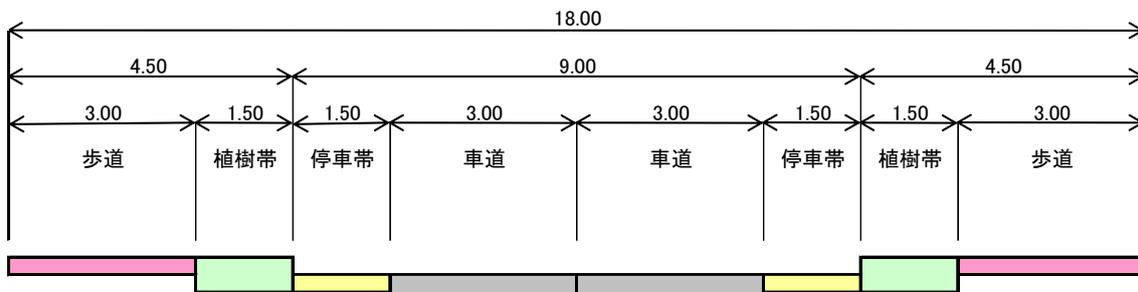
図 2-48 18m幅員道路断面
