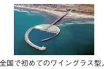
全国で初めてのフィングラス型人工島漁港。独特の形状は港内に砂での堆積に影響されない沖合に漁港を建設し、海岸から274mの道路橋で結んだもので、海浜の平衡状態保持を目的とし、周辺は海浜公園として整備され、釣り場としても人気があります。
